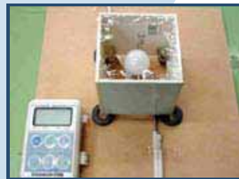
電球を密閉した箱を使った放熱性比較実験
