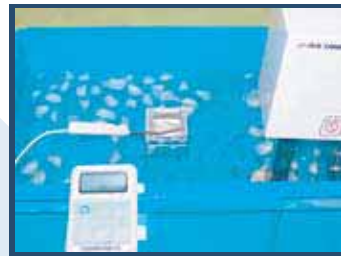
氷水と80℃の熱水を使った放熱性比較実験
